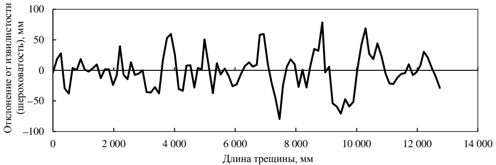
Рис. 3. Линия шероховатости трещины
