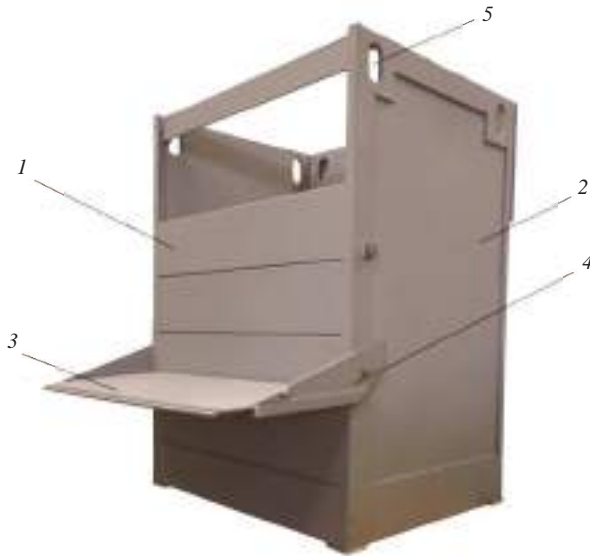
Рис. 1. Модель малотоннажного специализированного контейнера для сортового угля:
