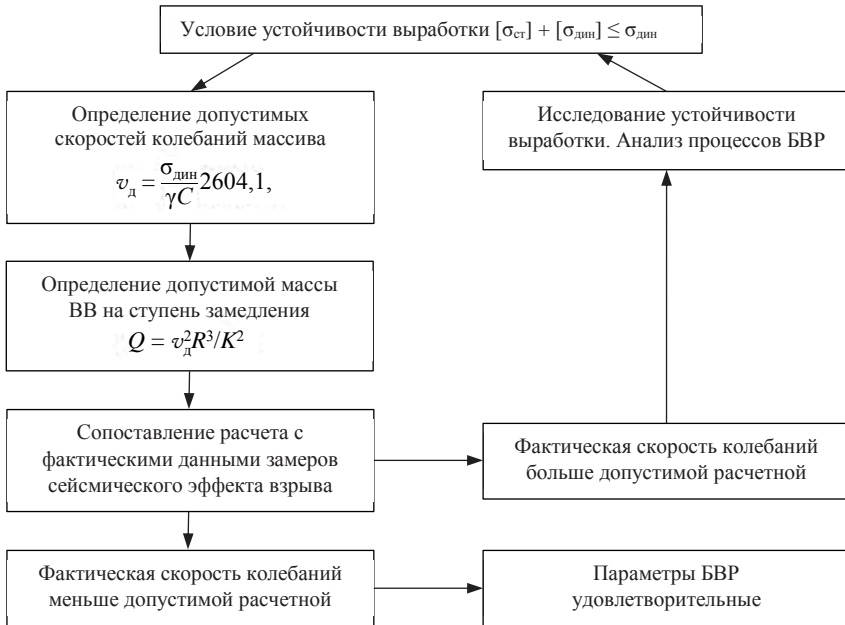
Рис. 1. Схема оценки сейсмического действия технологических взрывов
