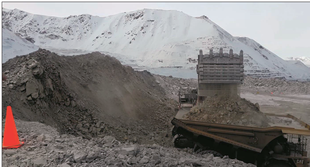
Рисунок 6. Визуальная оценка среднего куска породы Figure 6. Visual estimation of an average lump of rock
